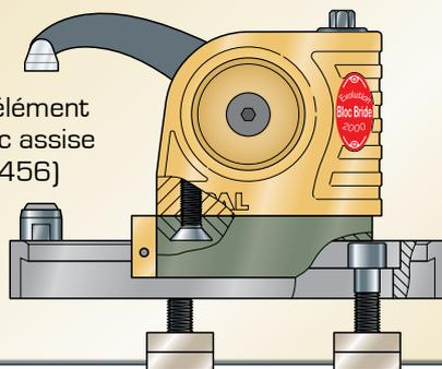
Ajuster la hauteur du tasseau de la bride ou de la rehausse par rapport à la hauteur de la rainure en laissant un jeu minimum
